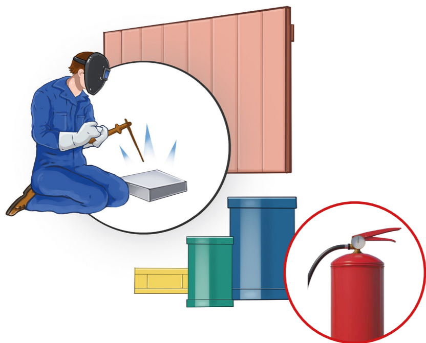
Место работ очистить от горючих материалов
