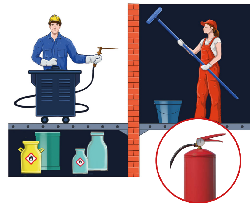
Прекратить в нижних и смежных помещениях окрасочные работы, удалить оттуда легковоспламеняющиеся и горючие вещества
