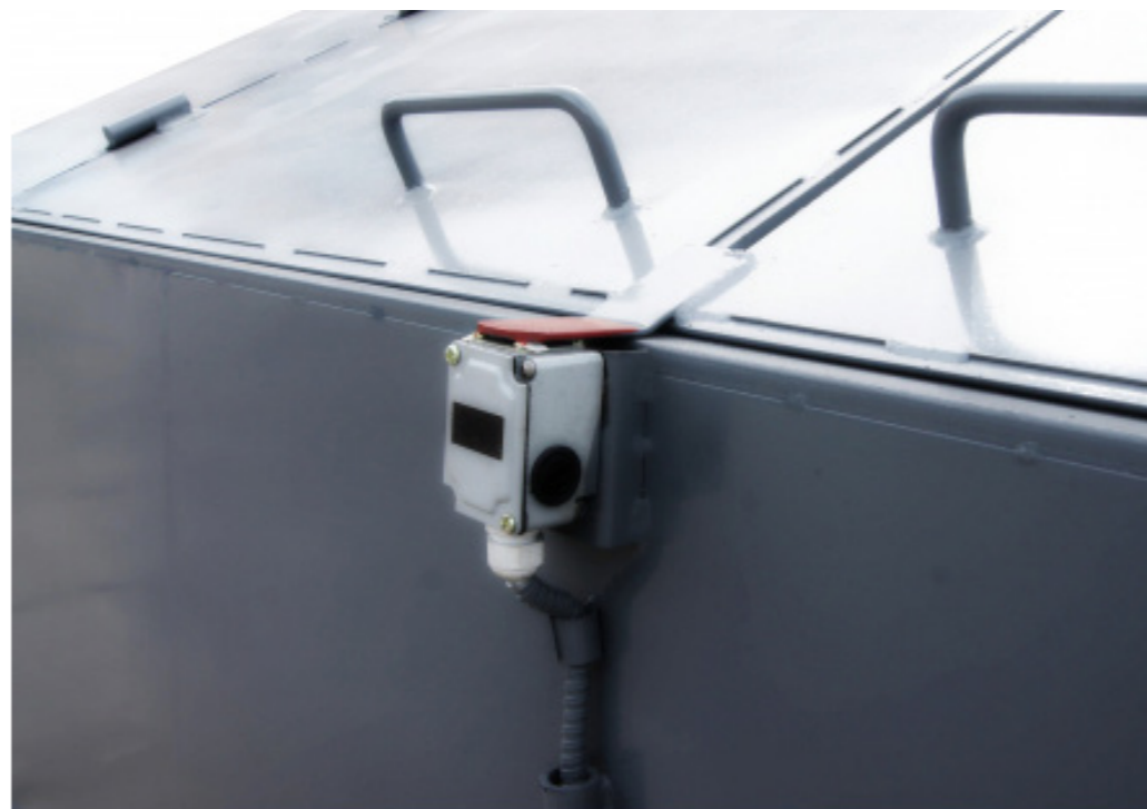
Наличие исправного концевого предохранителя.
